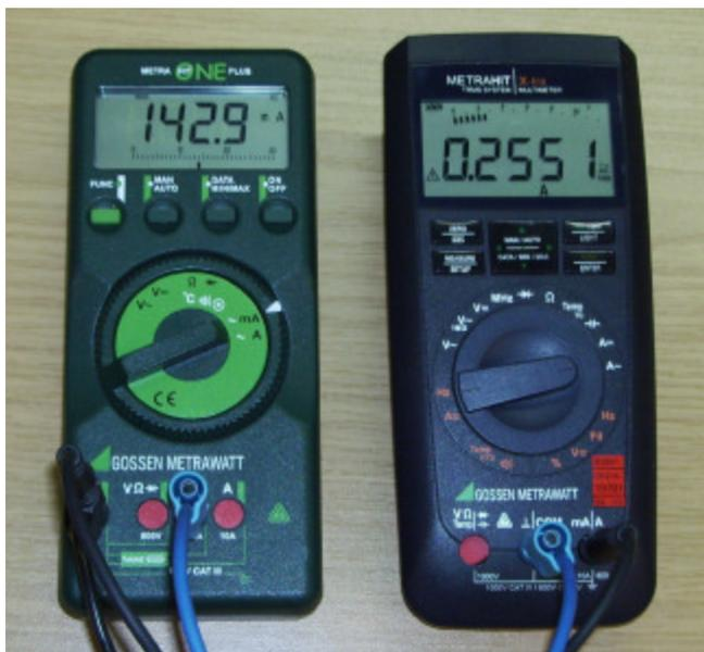
Abb. 8-1: Nur Geräte mit Echt-Effektivwertmessung (TRMS, rechts) messen kurvenformunabhängig richtig [14]
